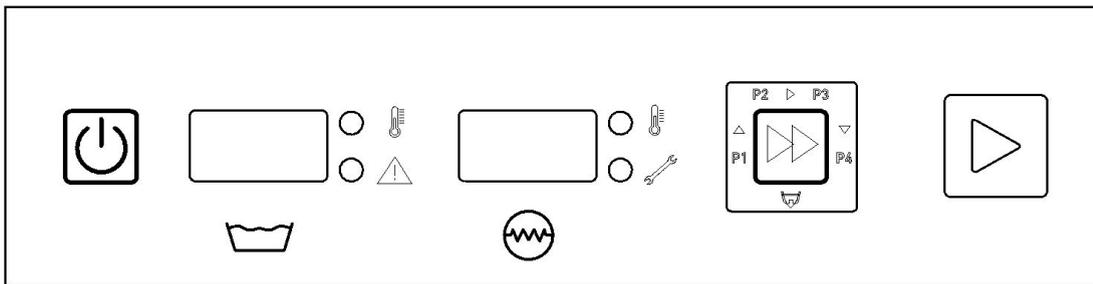
A display possono apparire dei codici ad indicare lo stato della lavastoviglie. I messaggi possono comprendere **messaggi di errore** (composti dall'indicazione "AL" seguito da un codice), **stato lavastoviglie**, **programma selezionato**, **temperature**, oppure spie ad indicare un allarme presente o una richiesta di manutenzione.
